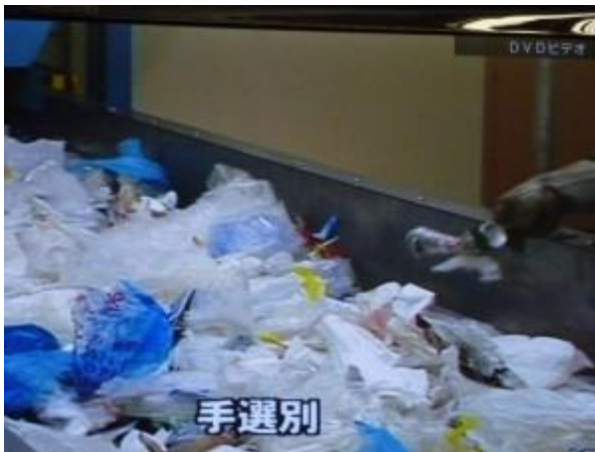
【プラスチックの選別】リサイクルは効率よく運ぶこと、異物を選別することがまず重要になります。これは人間の手で異物を選別する工程。
